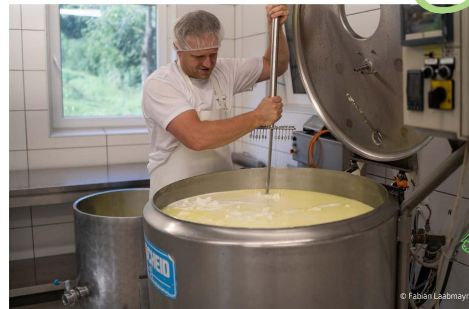
Nun werden Milchsäurebakterien und Lab hinzugegeben. Das führt dazu, dass die Milch nach etwa 40 Minuten verdickt. Daraus entsteht die sogenannte Gallerte. Johann schneidet gerade mit einer Käseharfe die eingedickte Milch, damit die Molke abfließen kann. Weichkäse benötigt einen höheren Molkeanteil.
